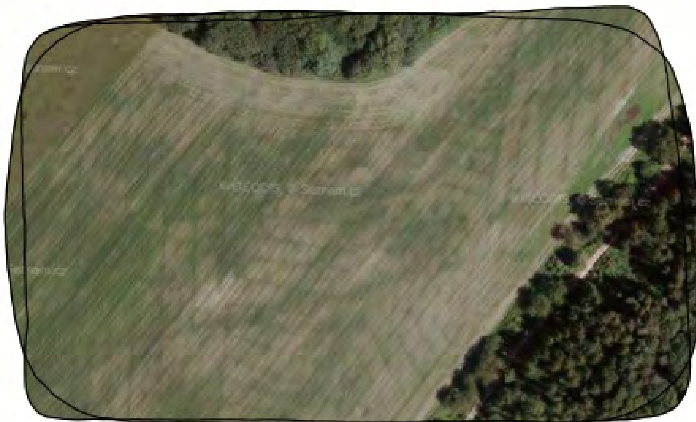
Letecký snímek z Bojkovic. Na obrázku je vidět meliorační soustavu z leteckého snímku. Meliorační systém odvodňuje půdu a odvádí vodu do toku. Takovou infrastrukturu máme na 25 % zemědělského půdního fondu. Jde o jednu z nejzásadnějších příčin sucha v krajině. (zdroj: mapy.cz)
